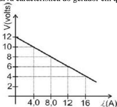
Determine a força eletromotriz, em volts, e resistência interna, em Ohm, da bateria.
