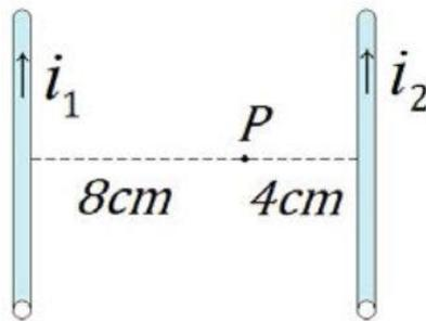
Determine a razão entre as intensidades dos campos magnéticos  $B_1/B_2$ , produzidos pelos dois condutores retilíneos no ponto P.
