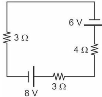
Qual é potência elétrica dissipada no resistor de  $4\ \Omega$ ? Use às leis de Kirchoff.
